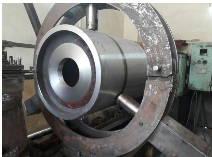
۸) سنگ محور قطر داخلی فلنچ ها جهت استقرار قفل کن ها (LOCKINGS)
